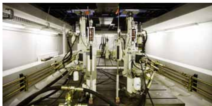
Tests auf dem KW 7-Post Fahrdynamikprüfstand liefern hochpräzise Daten für die Abstimmung des Fahrwerks.
