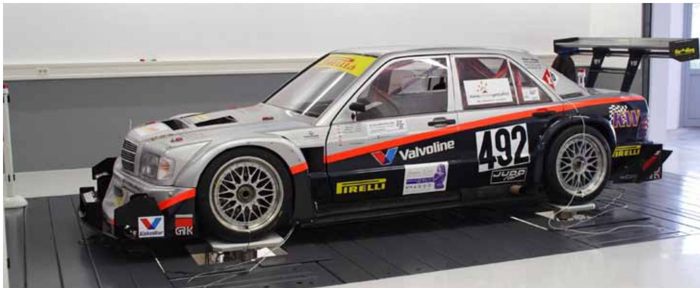
Optimierung von Fahrwerk-Setups auf dem innovativen KW 7-Post Fahrdynamikprüfstand (Fotos: KW automotive GmbH)
